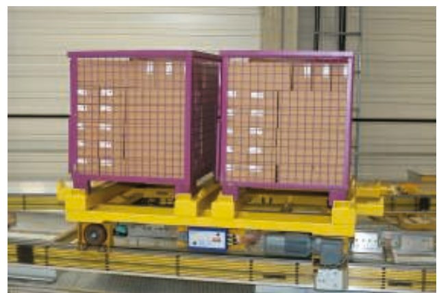
Bild 2 Mit Hilfe der Simulation fiel die Wahl des Fördersystems auf die Elektropalettenbahn.
