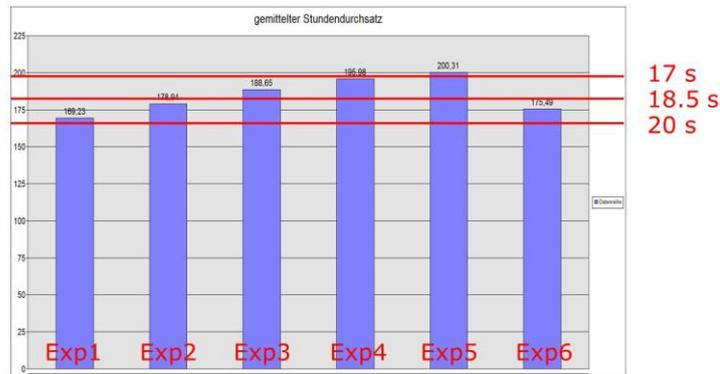
**Abbildung 4-3:** Durchsatz in Abhängigkeit von der Taktzeit und MTTR
