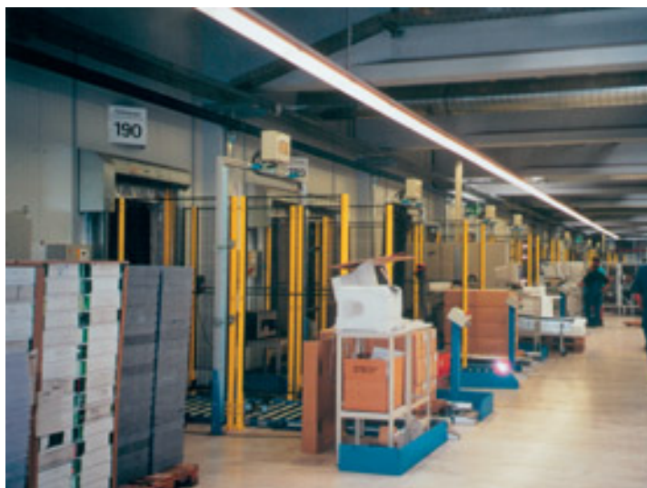
Effiziente Lagertechnik: Das Produktionspufferlager mit Regalbediengeräten
