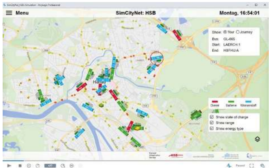
Abb. 1: Dargestellt ist die kartenorientierte Visualisierung des Simulationsmodells. Die Busse bewegen sich anhand des Fahrplans realitätsnah durch das Stadtgebiet und geben fahrzeug-spezifische Informationen zu Antriebstechnologie, Ladestand und Reichweite an.
