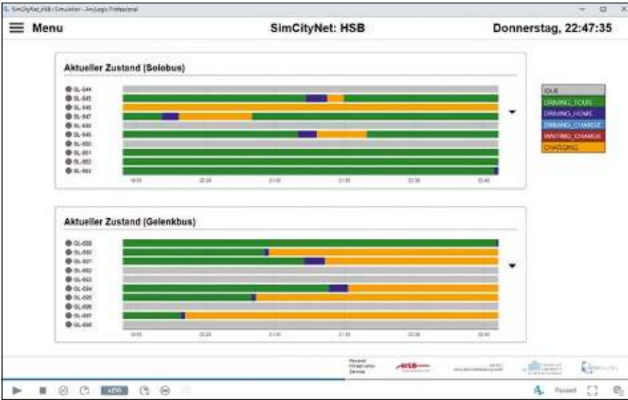
Abb. 2: Während der Simulation können Betriebsprozesse überwacht und bewertet werden. Dargestellt ist hier der aktuelle Betriebszustand der einzelnen Busse im Simulationsdurchlauf. Screenshot: Frankfurt UAS
