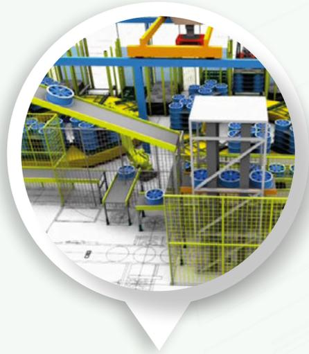
**Foto:** Simulationsmodell eines Reifenmontage-, -sortier- und -puffersystems
