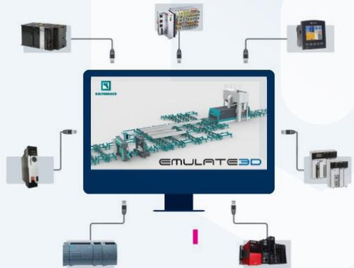
**Foto:** Modell eines Rockwell MagneMotion Systems und zugehörige Standardbibliotheken für Simulation, Emulation und SPS-Code Erzeugung von ICT-Anlagen.
